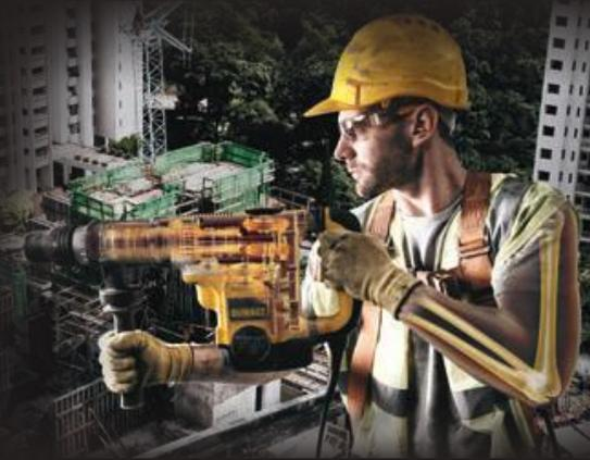
Existe uma possibilidade da ferramenta bloquear quando perfurar ou cortar. Isto poderia danificar a ferramenta ou provocar ferimentos pessoais.
