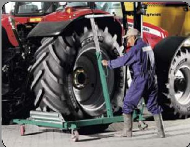
Capacidade para rodas grandes, de 1150 mm a 2150mm em diâmetro e 1050 mm em profundidade
