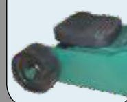
Borracha protetora do ponto de levantamento
